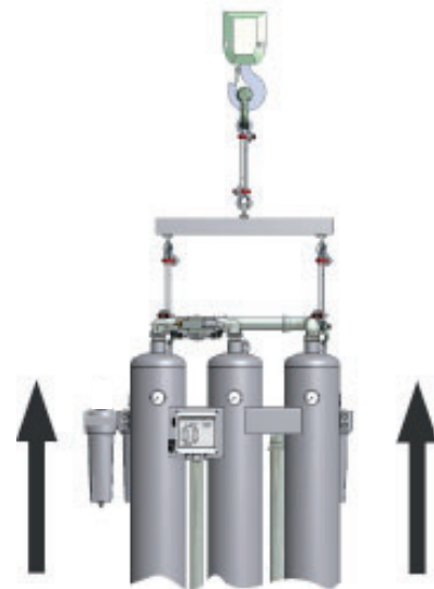
II: Aufstellen mit Kran
